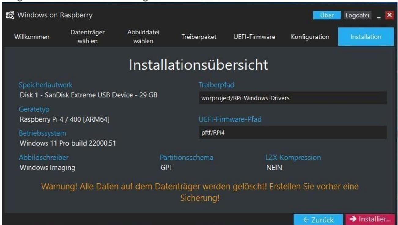
Starte nun die Erstellung der Windows Installation mit *Installieren*. Der Datenträger wird formatiert und alle benötigten Dateien gespeichert. Dies kann je nach Art des Datenträgers lange dauern. Also Geduld haben. Nach Abschluss den Datenträger unter Windows sicher entfernen und in den Pi stecken und booten. Vor dem ersten Boot müssen noch ein paar Änderungen im Bios getätigt werden. Hierzu beim booten die *ESC* Taste drücken um ins Bios zu kommen:
